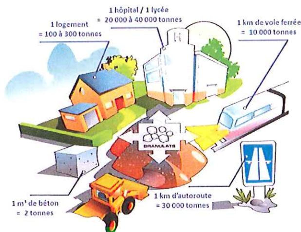
Figure 1 : Consommation moyenne de granulats par nature d'ouvrage (Source : UNPG).
